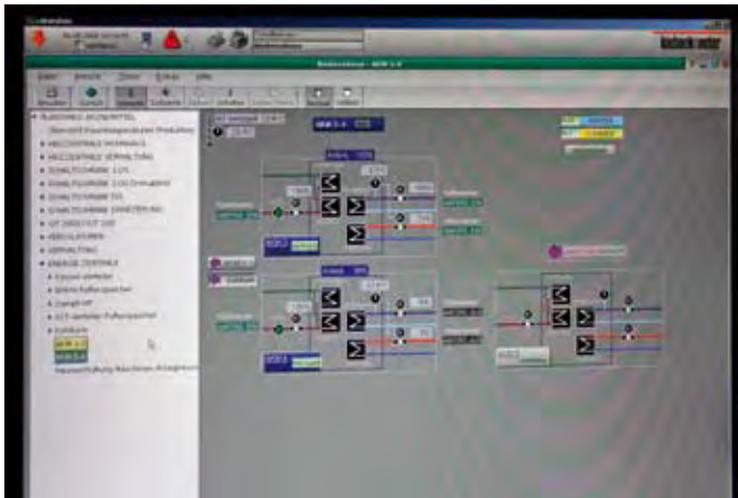
Pelletskessel, BHKW und AKM sind über Modbus auf die GLT aufgeschaltet
